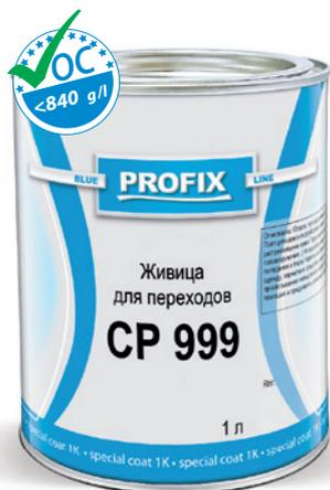
Живица для переходов **CP 999** используется при ремонте лакокрасочного покрытия для сглаживания цвета приготовленной эмали с существующим цветом автомобиля. Применяется с компонентами **CP 99 PREMIUM**. Предварительно нанести живицу на ремонтируемый элемент. Затем методом "мокрое по мокрому" нанести приготовленную для ремонта эмаль. Благодаря специальным свойствам смолы на стыке возникшего перехода не образуются "яблоки", а различие оттенков не невозможно заметить.
